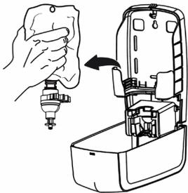
PRESS THE CLAMPS OF THE PUMP TOGETHER AND PULL THE PUMP OUT OF THE DISPENSER.
