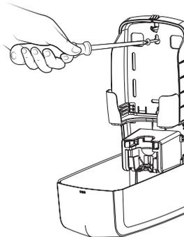
PUT THE DISPENSER BACK ON THE WALL AND SCREW FASTEN ACCORDINGLY.
