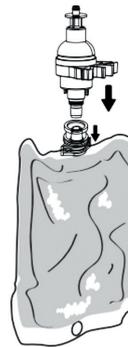
REMOVE THE PROTECTIVE CAP FROM THE SOAP REFILL BAG AND INSERT THE PUMP INTO THE SOAP BAG.
