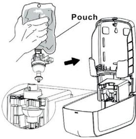
SECURE THE PUMP WITH CLAMPS AND MAKE SURE IT IS LOCKED IN THE SLOT.
